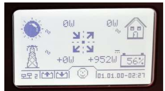
Puissance électrique livrée 952W
